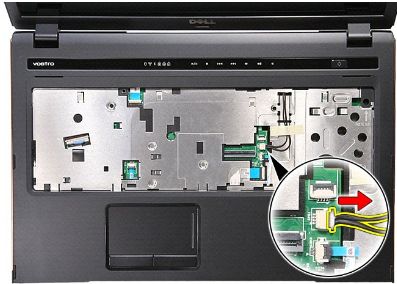
9. اقلب الكمبيوتر رأساً على عقب مع جع الجانب الأيمن متجهًا لأعلى. 01. افصل كابل مكبر الصوت من الموصل الموجود على لوحة النظام.
