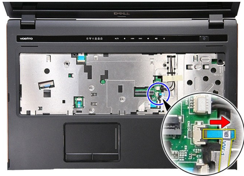
31. افتح المشبك المثبت لكبل الصوت في الموصل الخاص به في لوحة النظام.
